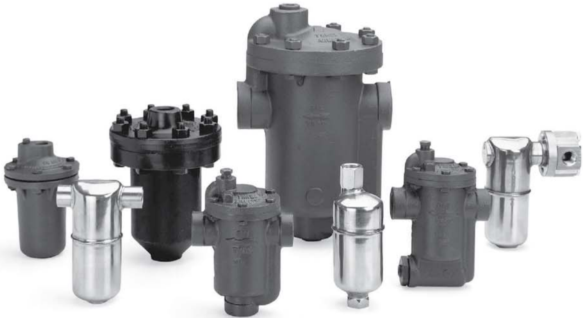
Armstrong ters kovalı kondenstopun küresel supabı aşınma oluştuğunda bile sit içinde daha derine oturarak tam sızdırmazlığı sağlar .
