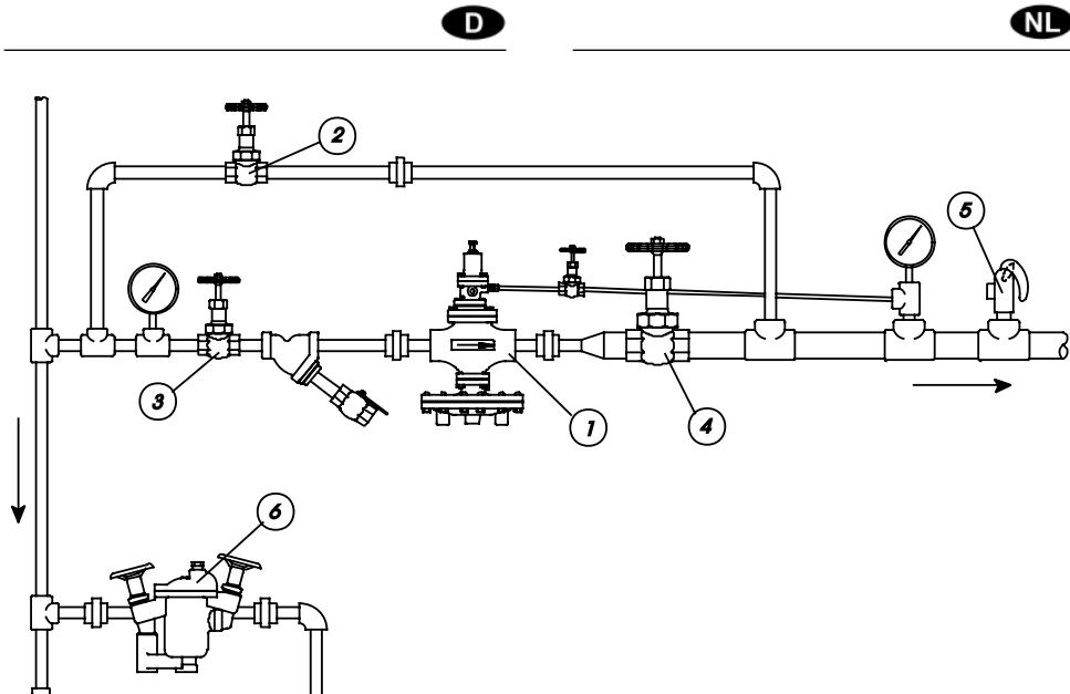
Un appel de débit en aval est nécessaire pour régler le détendeur.
